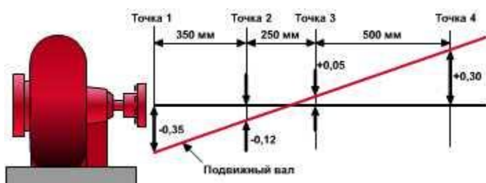
Рис. 1.11 Смещение вала. Отклонение оси вращения одного вала относительно оси вращения другого в заданной точке (или плоскости) по длине вала.
